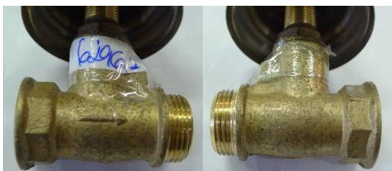
Falta de marcação no corpo do registro de pressão
