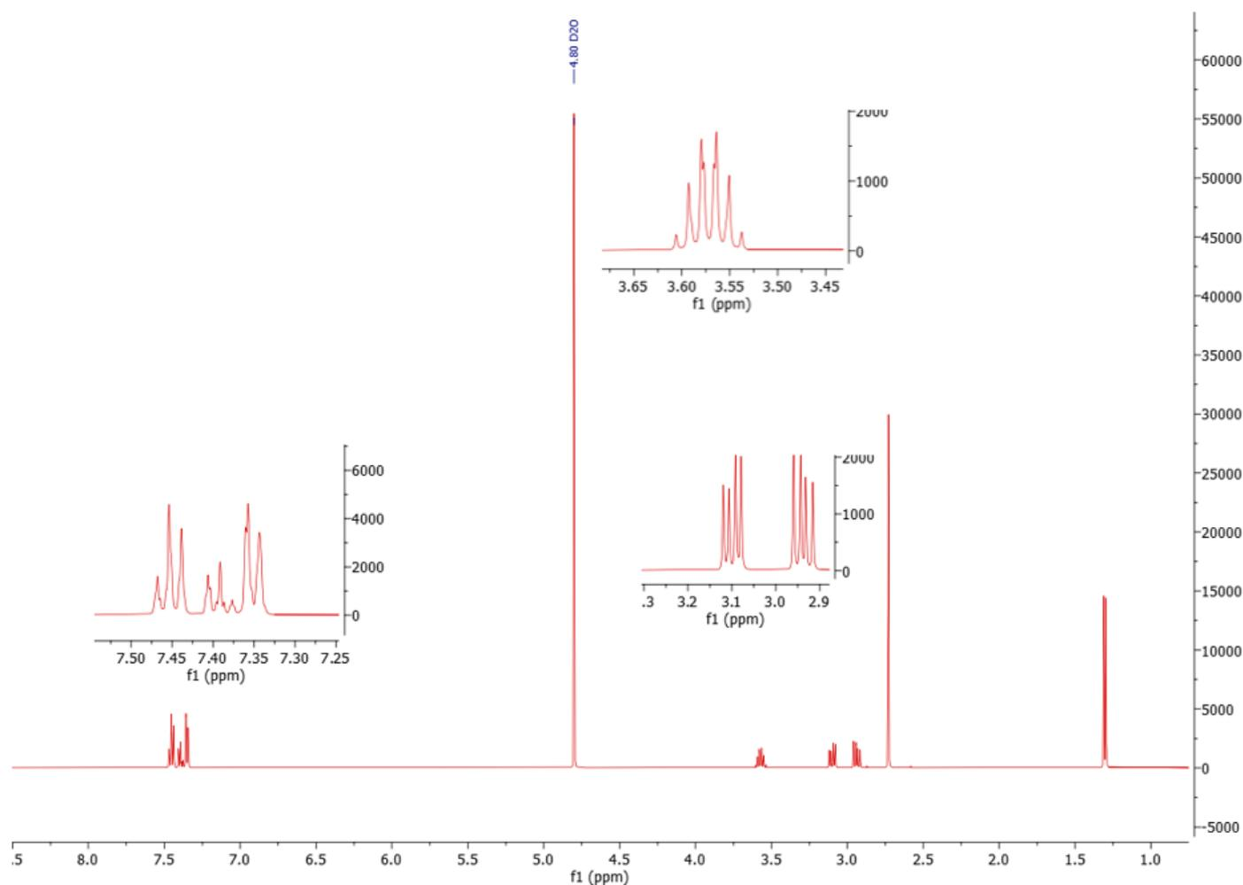
Figura 1: Espectro de RMN de  $^1\text{H}$  a 500 MHz para o MA.HCl em  $\text{D}_2\text{O}$
